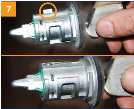
Zo wordt de veiligheidspal ingetrokken.
