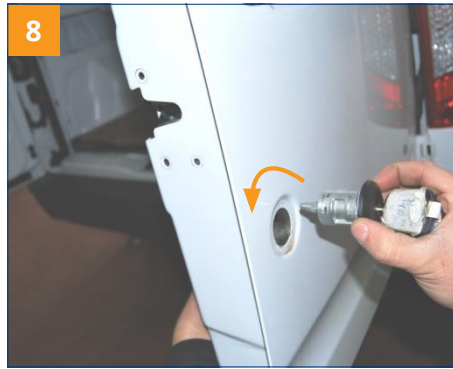
Draai de sleutel linksom en verwijder het slothuis.
